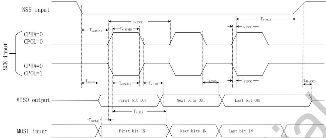
图 5-2 SPI 时序图-Slave mode and CPHA=0
